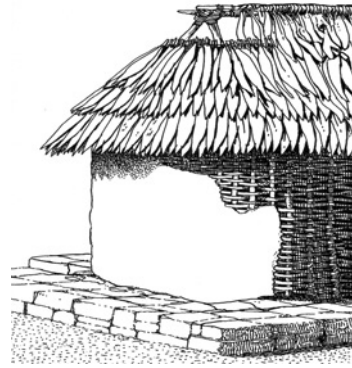
Abb. 11: Schon bald wurde erkannt, dass auf morastigem Untergrund während der Regenzeit eine Steinschicht von Vorteil ist. Man baute die Hütten teilweise aus Rohrgeflecht, das manchmal sogar mit Lehm verputzt wurde, auf einem steinernen Untergrund.
