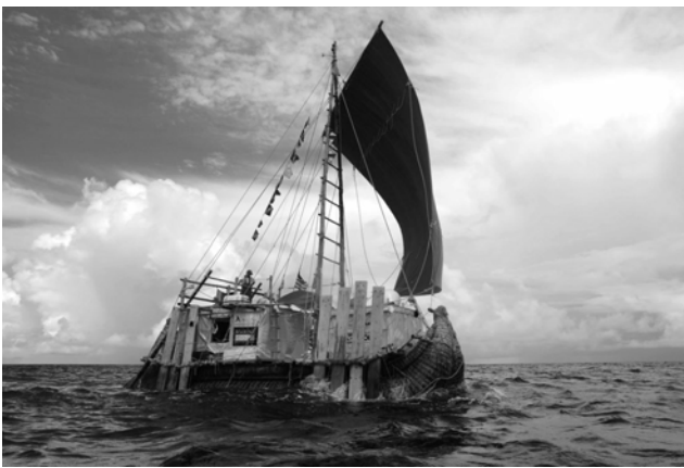
Abb. 12: Die Seitenschwert-Segeltechnik hat abermals funktioniert. Es gelang, ABORA III mehrfach bei günstigen Strömungsverhältnissen unter 80° am Wind zu segeln.
