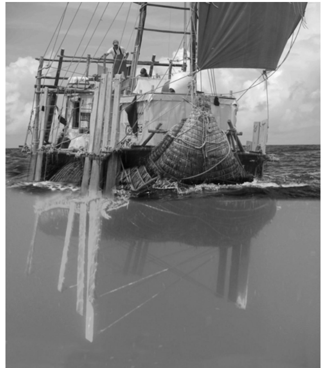
Abb. 6: Die Trickgrafik soll die Kielwirkung der Schwerter unter Wasser wiedergeben.
